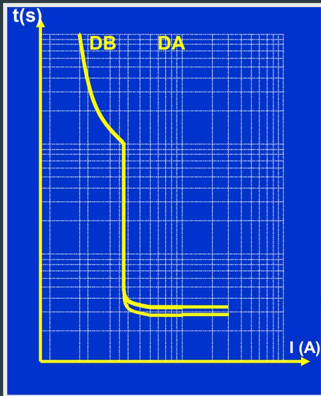
Technique qui repose sur le décalage temporel des courbes de déclenchement et qui se détermine graphiquement
