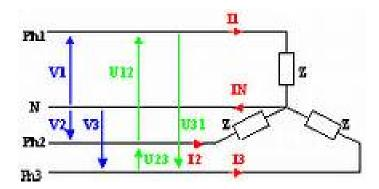
Dans un couplage étoile équilibré, les valeurs efficaces des tensions de ligne U et des tensions de phase V vérifient la relation :
