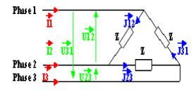
Dans le cas d'un triangle équilibré, chaque phase du récepteur est soumise à la tension de ligne U, de sorte que la tension de phase V est égale à la tension de ligne :
